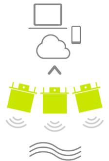
用三台雷达组成阵列, 可以在三个位置测量海面的高度。雷达安装使其投影在水面上形成一个三角形。知道水面的坡度, 就可以计算出完整的波向参数。由于系统中集成了一个高灵敏度的运动传感器, 测量到水面距离可以根据系统的升沉、纵摇和横摇进行运动补偿。该系统允许设置固定的方向偏移, 这意味着波浪的方向是根据船舶或其它浮动设施的参考坐标系计算的。
